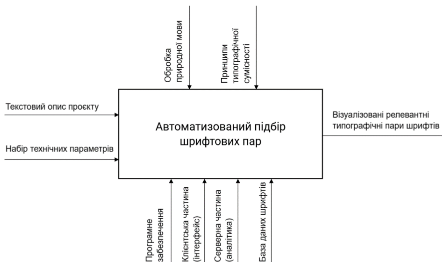
Рисунок 1 – Функціональна модель автоматизованої системи (IDEF0 діаграма)
