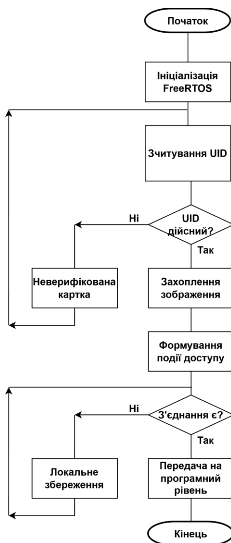
Рисунок 1 — Узагальнений алгоритм функціонування апаратного рівня системи
