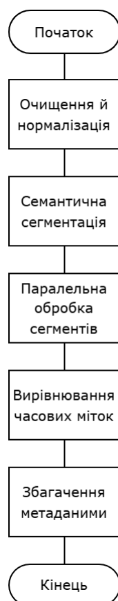
Рисунок 1 – Схема алгоритму паралельної семантичної обробки медіа-ресурсів
