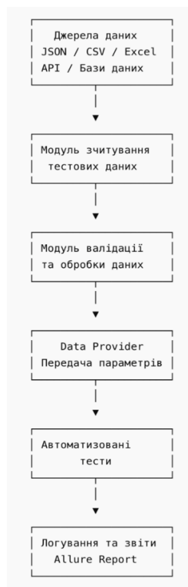
Рисунок 1 – Структурна схема механізму обробки тестових даних у фреймворку автоматизації
